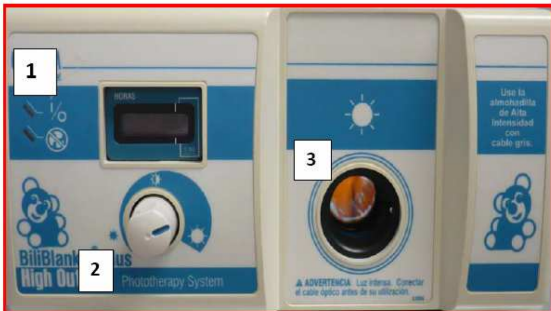
Figura 8: 1: indicador de encendido; 2: selector de intensidad; 3: conector del cable fibroptico.
